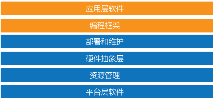
图 1-1 整体数据中心核心技术分层
